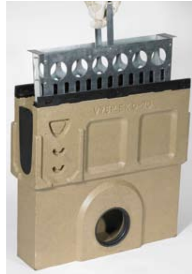
ACO DRAIN® Powerdrain – skrzynka odpływowa V 75 P z koszem osadczym ze stali ocynkowanej, z gumową ścianką do dostosowania dowolnej wysokości kanału, ze zintegrowaną uszczelką wargowo-labiryntową
